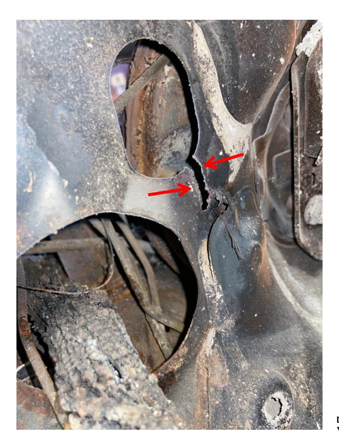
Metal em fusão preciptou no piso do veículo, junto aos pedais da acelerador e freio, iniciando incêndio nos materiais combustíveis existentes sobre o piso (tapete, carpete, etc).
