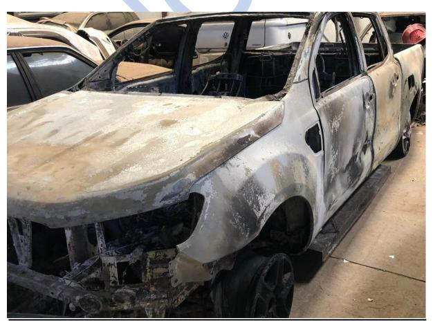
2- No habitáculo do veículo, constatamos que todos os materiais combustíveis foram comburidos, do piso ao teto (carpetes, tapetes, estofamentos e revestimentos dos bancos, forrações das portas, painel de instrumentos, forro do teto, etc.)
