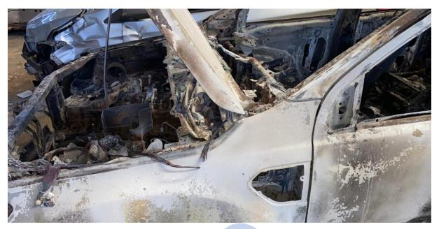
O mapeamento das áreas comburidas e deformadas pelo calor, acima descritos, nos permitem afirmar categoricamente que as fusões na carcaça do veículo, constatadas, estavam inseridas na região do FOCO INICIAL DAS CHAMAS, em materiais combustíveis existentes junto ao piso do habitáculo do veículo e, portanto, constituíram os AGENTES ÍGNEOS que deram início às chamas.
