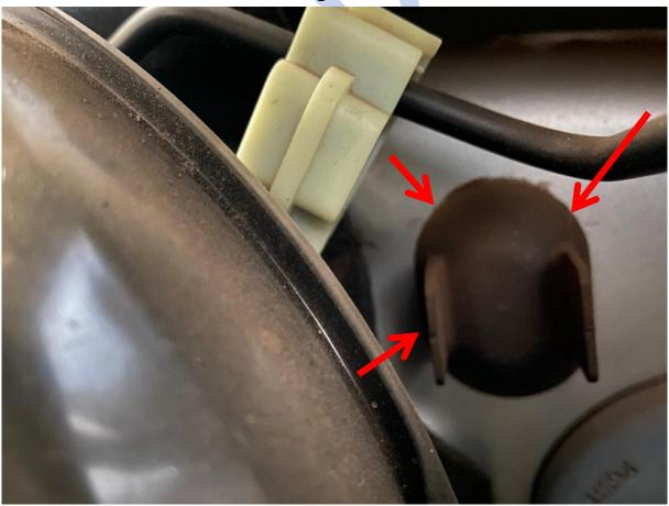
No veículo incendiado, a peça plástica (indicada pelas setas vermelhas) foi retirada para dar passagem ao cabo do sistema de som.
