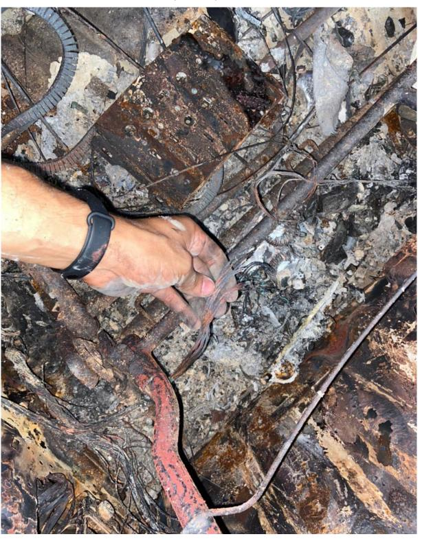
No entanto, constatamos os vestígios inequívocos de curto-circuito, ocorrido entre um cabo elétrico, conectado ao polo positivo da bateria, e a carcaça do veículo (ligada ao polo negativo). O cabo elétrico, de bitola 4 Awg, conectava o polo positivo da bateria (conector instalado ao lado da bateria, no cofre do motor) ao amplificador de "caixas de grave", instalada atrás do encosto do banco traseiro do veículo.
